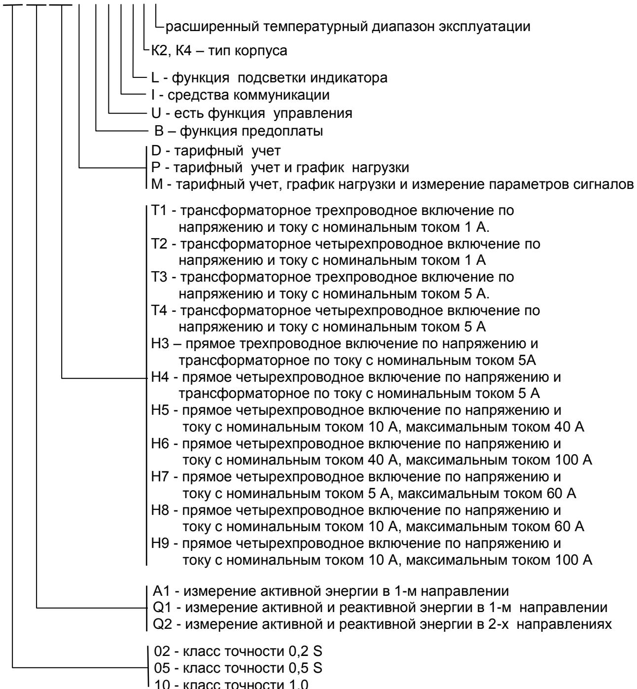
Примечание - В обозначениях счетчиков буквы после точки присутствуют только при наличии соответствующих функций
