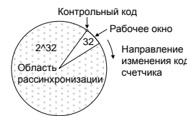
Рис. 5. Диаграмма синхронизации счетчика пульта с контрольным кодом.
