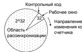
Рис. 6. Диаграмма синхронизации счетчика брелока с контрольным кодом.
