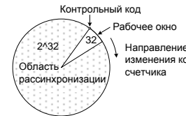
Рис. 6. Диаграмма синхронизации счетчика брелока с контрольным кодом.
