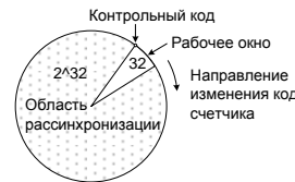
Рис. 6. Диаграмма синхронизации счетчика брелока с контрольным кодом.
