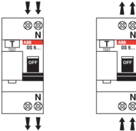
*La alimentación del interruptor puede ser realizada indiferentemente aguas arriba o aguas abajo.*
