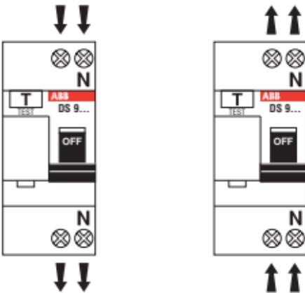
*Die Speisung des FI/LS kann unabhängig von oben oder unten ausgeführt werden.*
