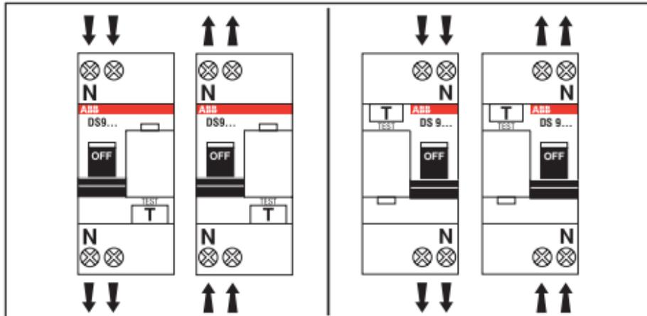
*L'alimentation de l'interrupteur peut être réalisée indifféremment en amont ou en l'aval.*
